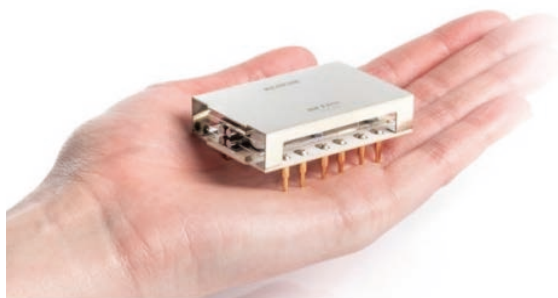
Micsosaic Systems 公司推出的基于 MEMS 技术的 MiD 小型质谱
